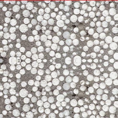
Lösung mit Luftporenbildner für die Anfertigung von Frost-Tau- Wechselbelastung- und tausalzausgesetztem Beton oder für Leichtbeton (Beton mit Polystyrol, Beton mit Perlit, etc.). Kompensiert den stellenweise geringe Gehalt an feinen Füllstoffen im Konglomerat, verbessert sein Aussehen, erhöht die Kohäsion, Standfestigkeit, Haftung und die Pumpfähigkeit . Es verbessert die Verarbeitbarkeit, verringert Segregation und Auslaufen.
