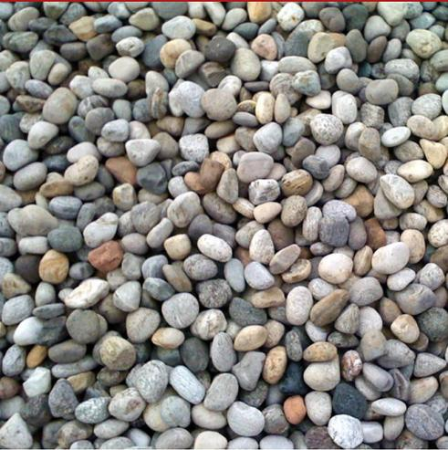
Getrockneter Kies, ausgewählt in der Partikelgröße zwischen 6 und 10 mm, speziell für die Zugabe in vorgemischten, strukturellem Verputz und Mörtel, sowohl thixotrop als auch gießfähig, um die granulometrische Kurve zu verbessern oder zu korrigieren, auf Basis der erforderlichen Erhöhung der Schichtstärke des Gusses.
