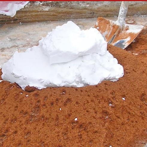
Zusatzstoff auf Basis von "alten" gemahlenen Ziegeln und Fliesen, hinzugefügt in einer Mischung aus hydraulischem Kalk und Zuschlagstoffen, zur Herstellung von Mörtel, Putz und Unterputz, vergleichbar mit der traditionellen Mischung des "cocciopesto" (italienische Putzmischung aus Grubenkalk, natürlichen Zuschlagstoffen und Ziegelmehl), welches für Eingriffe im ökologischen Bauwesen und in Restaurierung von alten Gebäuden und Denkmälern verwendet wird.
