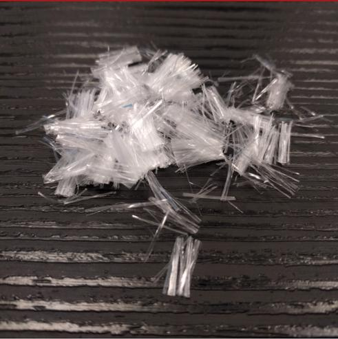
Readymesh PW-120 ist eine fibrillierte Polypropylen-Hilfs-Mikrofaser, mit einer Länge von 12 mm, geeignet für die Zugabe in Zementkonglomeraten im Allgemeinen. Die Zugabe von Readymesh PM-060 zu dem Gemisch, ermöglicht dem Phänomen der Rissbildung aufgrund plastischer Schwindung des Betons entgegenzuwirken, sowie positive Auswirkungen im Hinblick der Verformbarkeit der Mischung, Beständigkeit gegen Einfrier- und Auftauzyklen, Schlagfestigkeit und der allumfassenden Wasserdichtigkeit zu haben.
