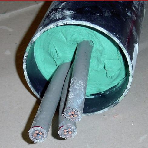
Versiegelnde, einkomponentige, dauerplastische, leicht expansive (+ 10% in Volumen bei Kontakt mit Wasser) Mischung, zur Wasserabdichtung von unterirdischen Löchern im Mauerwerk, durch welche ein oder mehrere Kabel und / oder technische Leitungen verlaufen. Es wird mittels einer spezifischen Dosierungs-Pistole für 600 ml Säcke, um die durchlaufenden Kabel extrudiert und dann mit thixotropem Mörtel Repar Tix G2 bedeckt.
